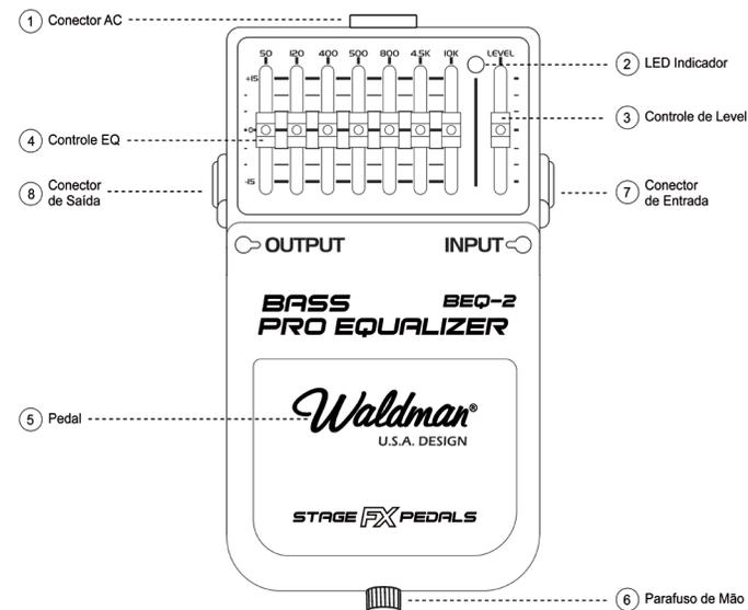
1. Conectando um instrumento a este conector automaticamente ligará o aparelho. Certifique-se de desconectar os cabos deste conector quando o aparelho não for utilizado por um longo período.
